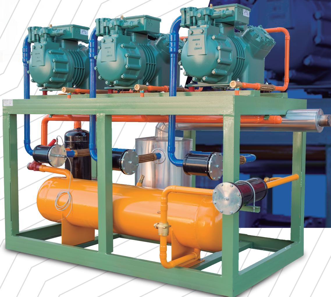
Este equipamento trabalha com fluido refrigerante halogenado e pode ser fabricado com controles automáticos de proteção e capacidade.
