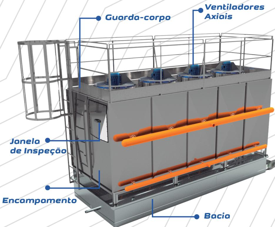
Os condensadores evaporativos Tecnofrio são equipados com bacia coletora de líquido, bóia de controle de nível de água, bombas de água, chuveiros, ventiladores axiais, janela de inspeção, tela para filtragem de resíduos e se necessário, guarda-corpo e escada de acesso.
